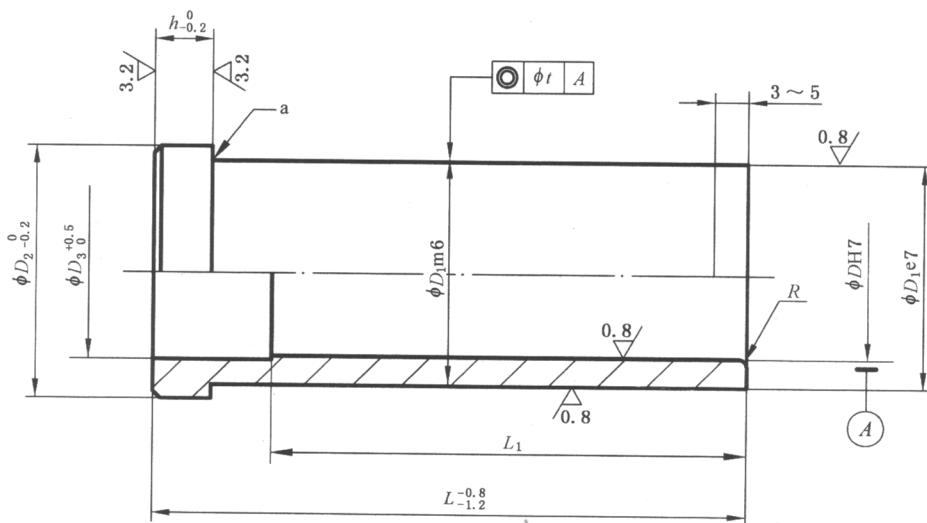
未注表面粗糙度  $R_a=6.3 \mu\text{m}$ ；未注倒角  $1 \text{ mm} \times 45^\circ$ 。
