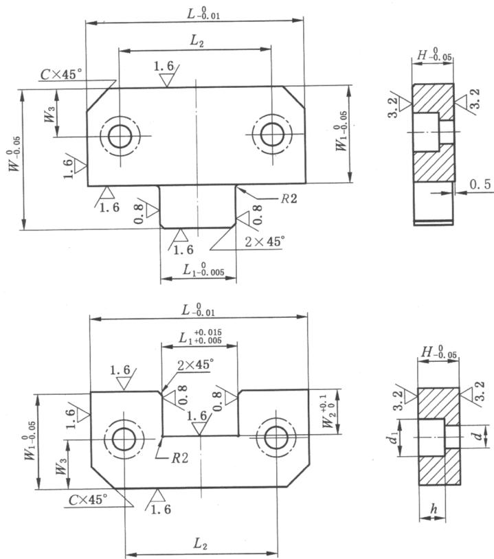
未注表面粗糙度  $R_a = 6.3 \mu\text{m}$ ；未注倒角  $1 \text{ mm} \times 45^\circ$ 。
