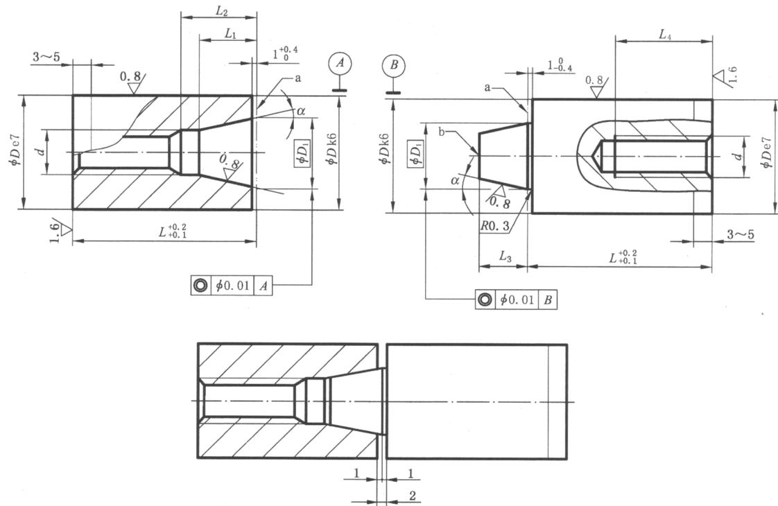
未注表面粗糙度  $R_a=6.3 \mu\text{m}$ ；未注倒角  $1 \text{ mm} \times 45^\circ$ 。
